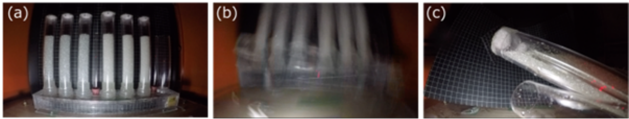
Fig. 1 落下塔実験装置の大破の様子。鉛直に6本立てた多孔質体カラムが(a)、カプセルの着地の衝撃で飛び上がり(b)、バラバラになった(c)。
