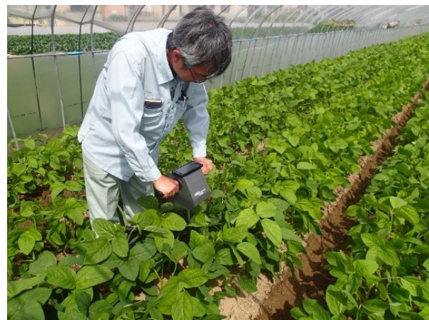
Photo 2 現地での貫入硬度の測定。
