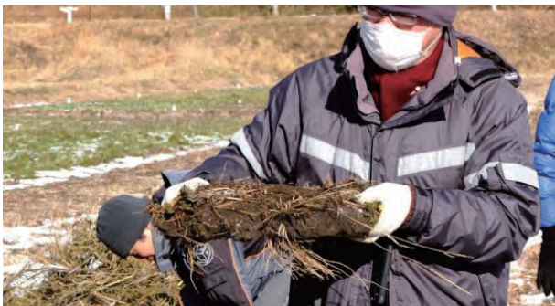
Fig. 4 放射性セシウムを含む凍土の剥ぎ取り実験 (2012年1月8日)。
