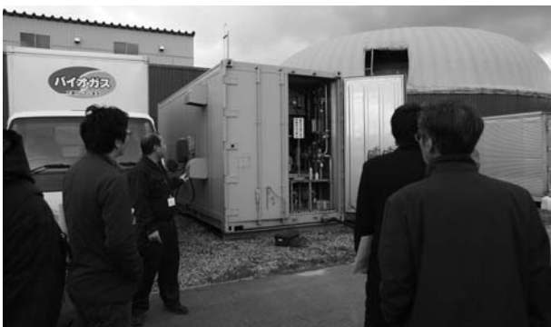
Photo. 6 製造されたバイオガスを利用して走る車とガス充填装置。
