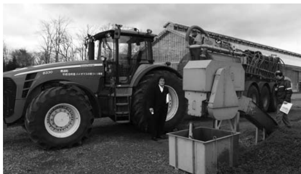
Photo. 5 製造された消化液を畑に散布するための作業機。
