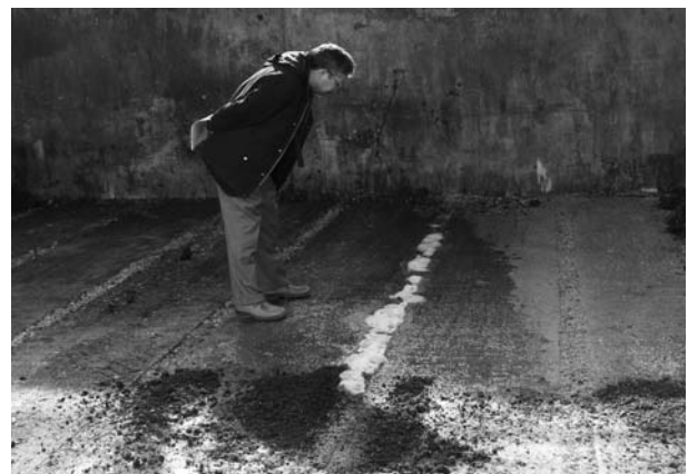
Photo. 11 堆肥の下面から空気を送り込んで発酵を促す装置。
