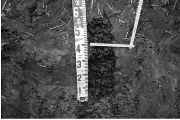
Fig. 14 施工後7年経過木質系チップの状況.
