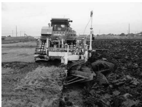
Photo. 2 二段耕プラウ。 Two-stage plow.
