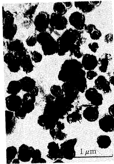
図-4 球状ハロイサイトの電顕写真(庄子貞雄氏)(文献(8)p. 177より引用)
