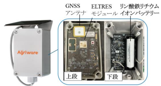
Fig.2 ELTRES 型ロガー(スマートロジック社)
