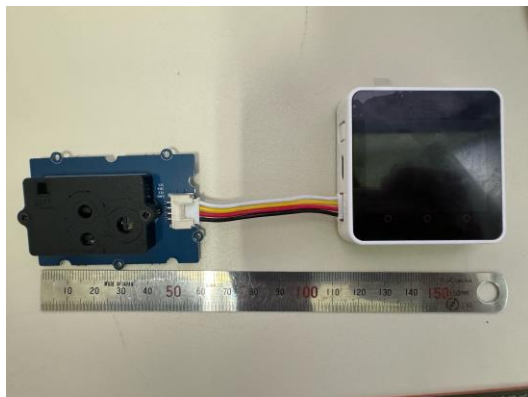
Fig. 1 M5StackCore2 を用いた CO 2 測定システム。
